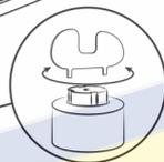
! Ajustando la perilla del dispositivo se adapta a terrenos irregulares.
